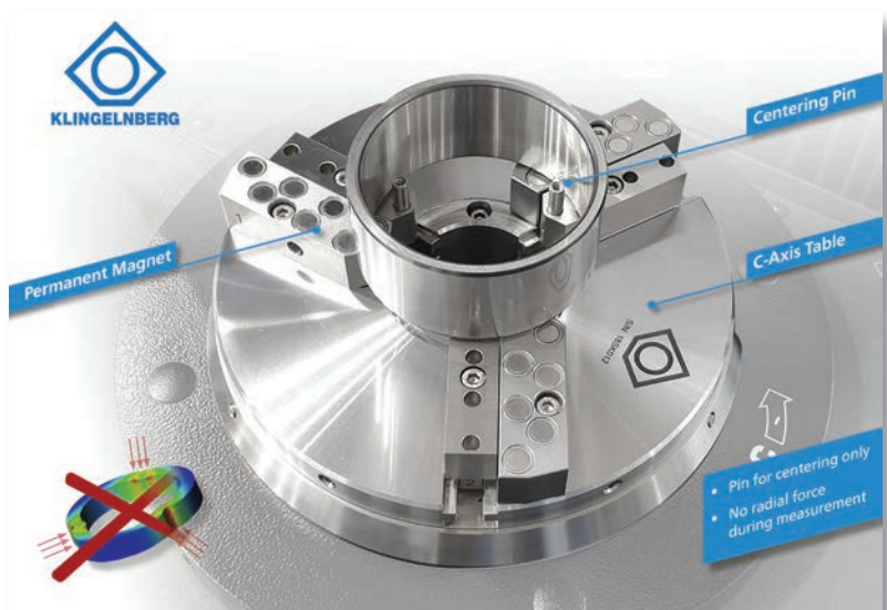
Abbildung 2: Hochpräzisionsdrehtisch mit durchdachter Aufspannung
