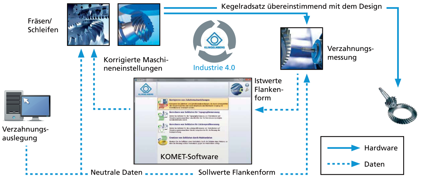
Abb. 3: Prozesskette Kegelrad-Fertigung im Closed-Loop
