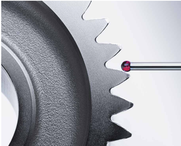
Analyse des Spektrums der Welligkeit mittels Allzahnmessung
