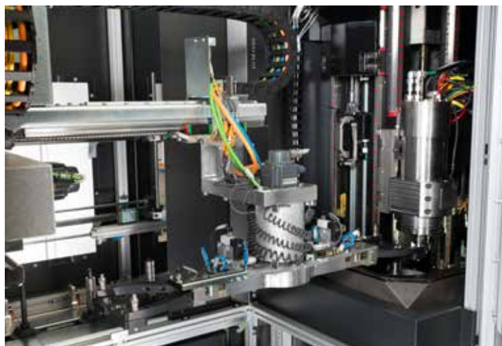
一体型スイベルローダによるワークスピンドルのダイレクトローディング
