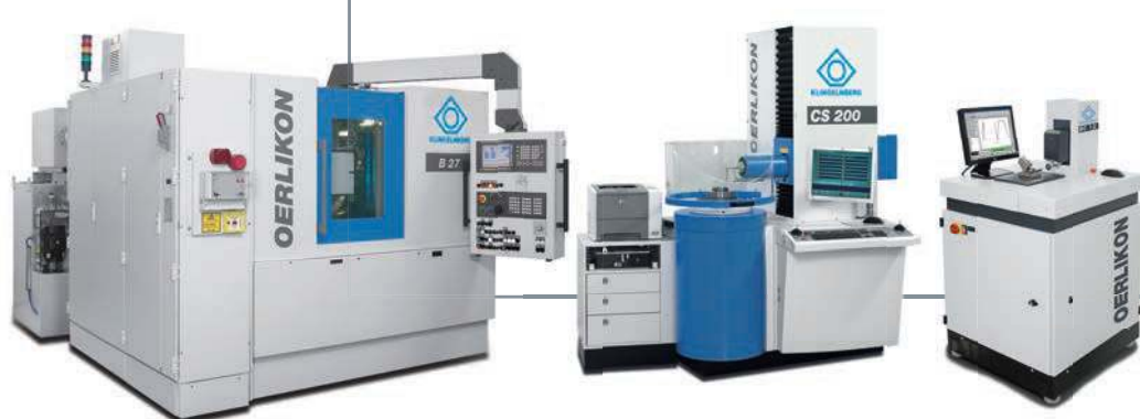
Oerlikon (奥利康) 刀条磨削机床B 27、Oerlikon (奥利康) 刀盘安装和检查仪CS 200和 Oerlikon (奥利康) 刀条测量仪BC 12诸多细节展示
