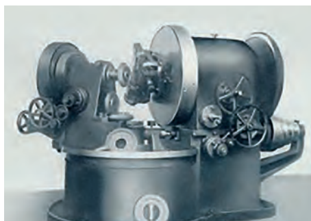
Die erste im Werk Hückeswagen gebaute Wälzfräsmaschine, Modell FK 150, Baujahr 1923
