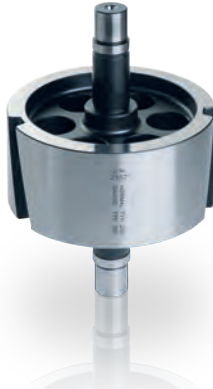
Abb.: Evolventen- u. Steigungsnormal Typ 200 (353160A)
